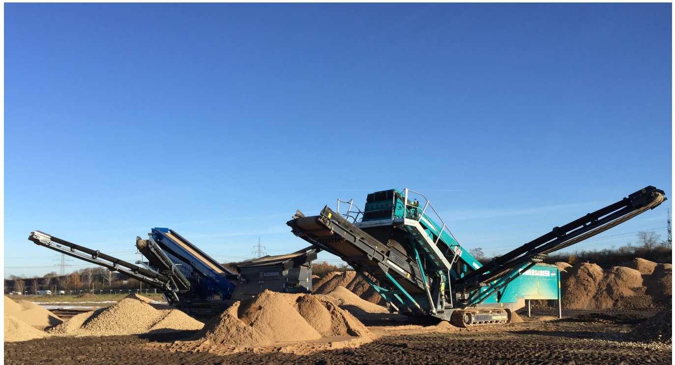
Hier ist eine Siebanlage zur Kiesaufbereitung zu sehen (Foto ©Fa. Kühl)
